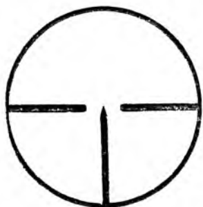
Рис. 6. Прицельный пенек и боковые выравнивающие нити прицела П. О. Т.
